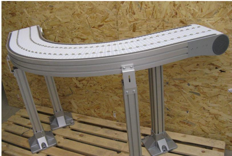
Figura 2. – Immagine del prototipo di convogliatore (circa 2m di lunghezza).
