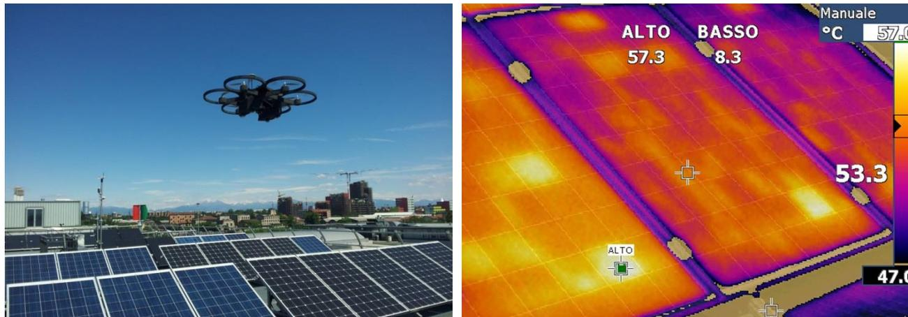
Figura 1. Piattaforma UAV utilizzata per le prove sperimentali e immagini riprese con una camera IR presso il SolarTech<sup>Lab</sup>
