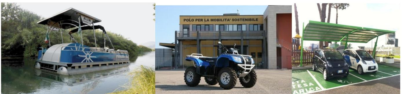
Fig. 1: Valentino I (battello elettrico), Quad elettrico ed infrastruttura di ricarica rapida in DC, progettati e realizzati presso i laboratori del POMOS
